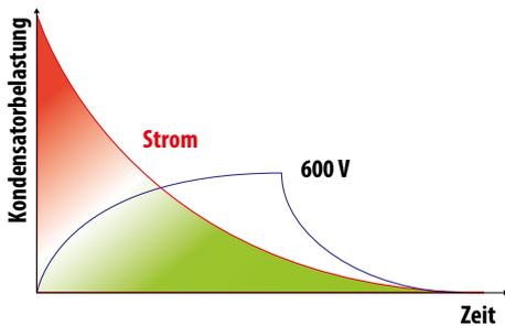
Bei der herkömmlichen Formierung wird eine zunächst **stark ansteigende Spannung** auf die Baugruppe gegeben, die allmählich abflacht, bevor die Betriebsspannung (hier beispielhaft 600V) erreicht wird. Dadurch schießt der dabei fließende Strom am Anfang direkt in die Höhe. Die **Belastung für die Kondensatoren** ist dabei **zu hoch**, falls eine Isolationsschicht schon zu stark überlagert wurde.
