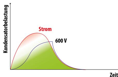
Beim BVS-Schonverfahren wird die **Spannung in langsam ansteigenden und wieder abflachenden Wellen** so vorsichtig erhöht, dass sich selbst überlagerte Isolationsschichten regenerieren können, da die Strombelastung nur langsam ansteigt. Erst nach einer vollständig durchgeführten Formierung legen wir Volllast an die Baugruppe an, um die volle Belastbarkeit der Kondensatoren zu prüfen.
